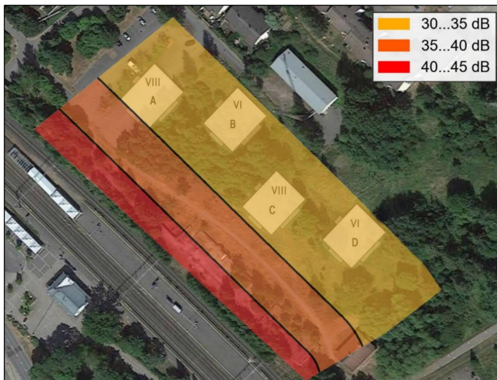
Kuva 3: Arvioidut runkomelutasot rakennuksen ensimmäisessä kerroksessa, sisältäen 5 dB varmuusvaran. Rakennusten on oletettu olevan betonirunkoisia .
